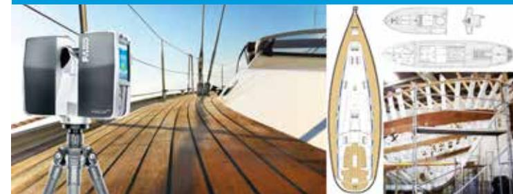
Aplicación de técnicas geomáticas para la definición métrica 3D de alta precisión de elementos navales.
